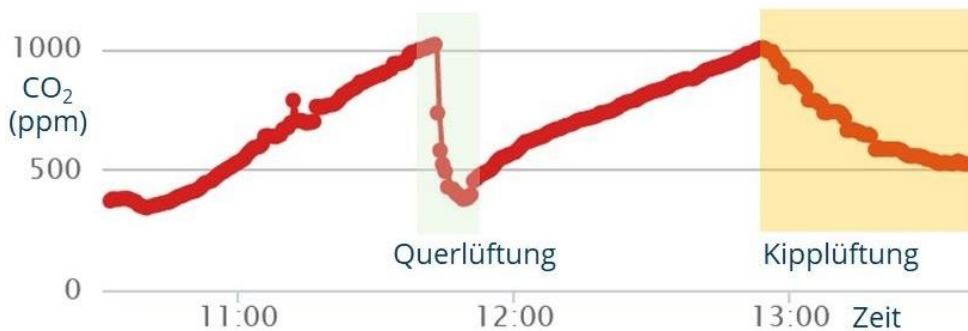
Einfluß der Lüftungstechnik
